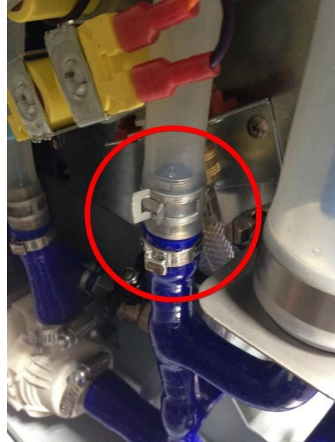
Raccordez le tuyau du condensat
